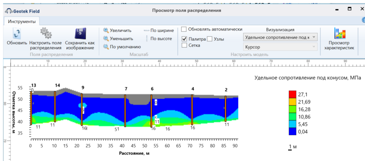
Рис. 12.32. 3D Кригинг. Поле распределения удельного сопротивления конуса по всей глубине исследуемого массива грунтов
