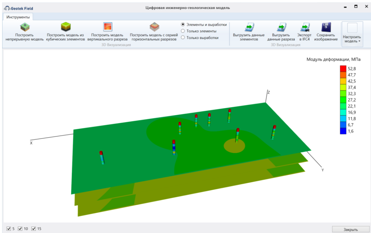
Рис. 12.26. Визуализация трех горизонтальных разрезов. Функция «Построить модель с серией горизонтальных разрезов»
